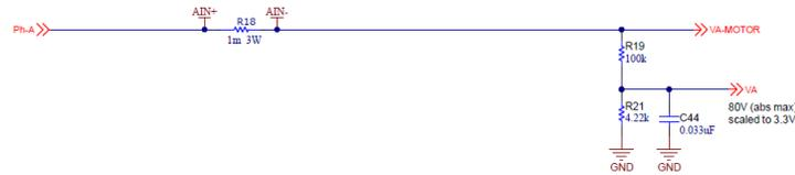
図 3-4. 位相 A 電圧センシング回路
