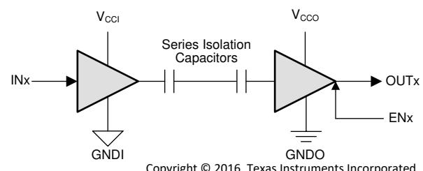
V<sub>CCI</sub>=入力電源、V<sub>CCO</sub>=出力電源
